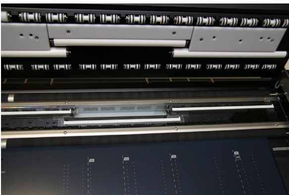
Abb. 2: Die CIS-Sensoren des Graphtec-Scanners („weiße Streifen“)
