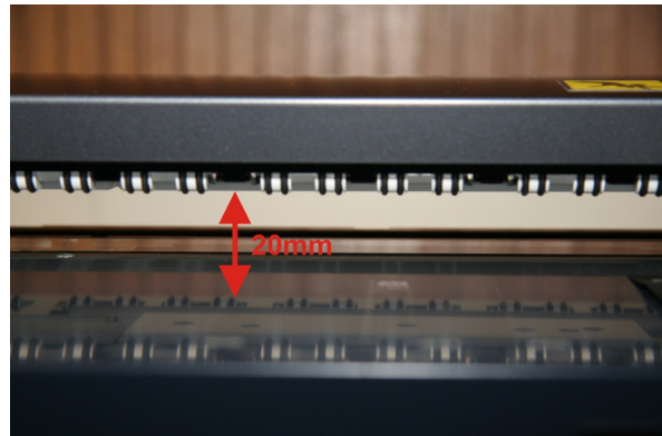
Abb. 3: Höhenverstellbare Andruckrollen ermöglichen es, bis zu 20 mm starke Vorlagen einzuscannen
